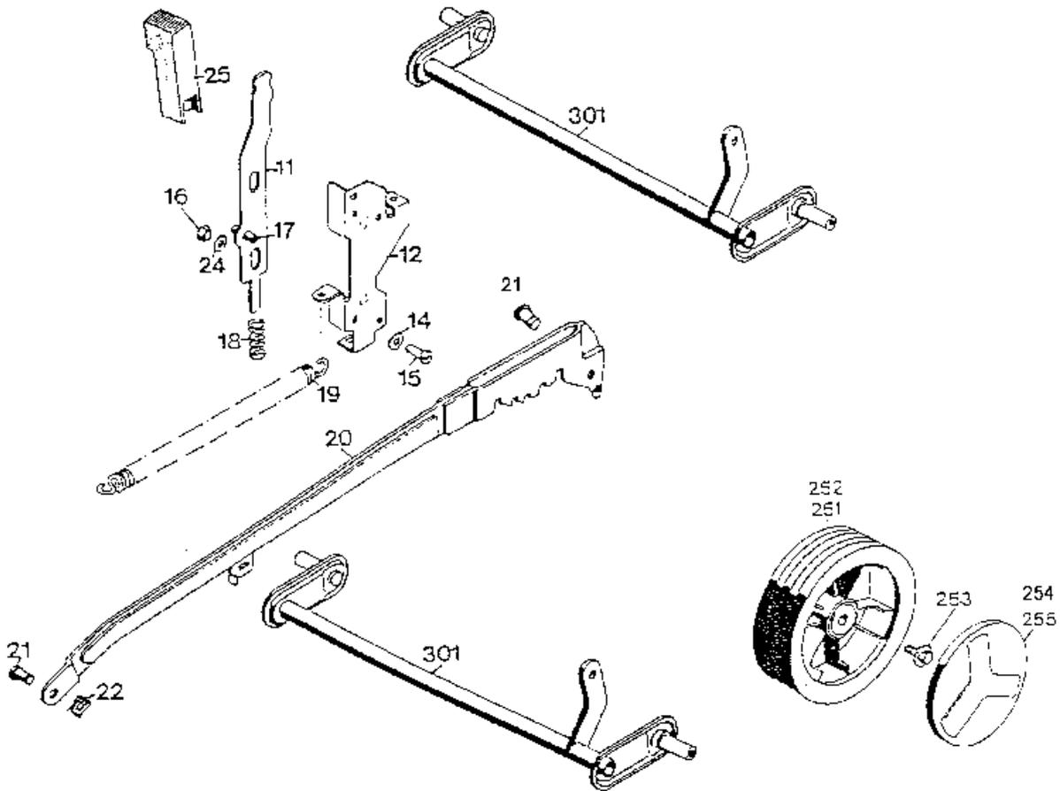
**Gerät: 6.42 B (Achse, Räder & Höhenverstellung)**
