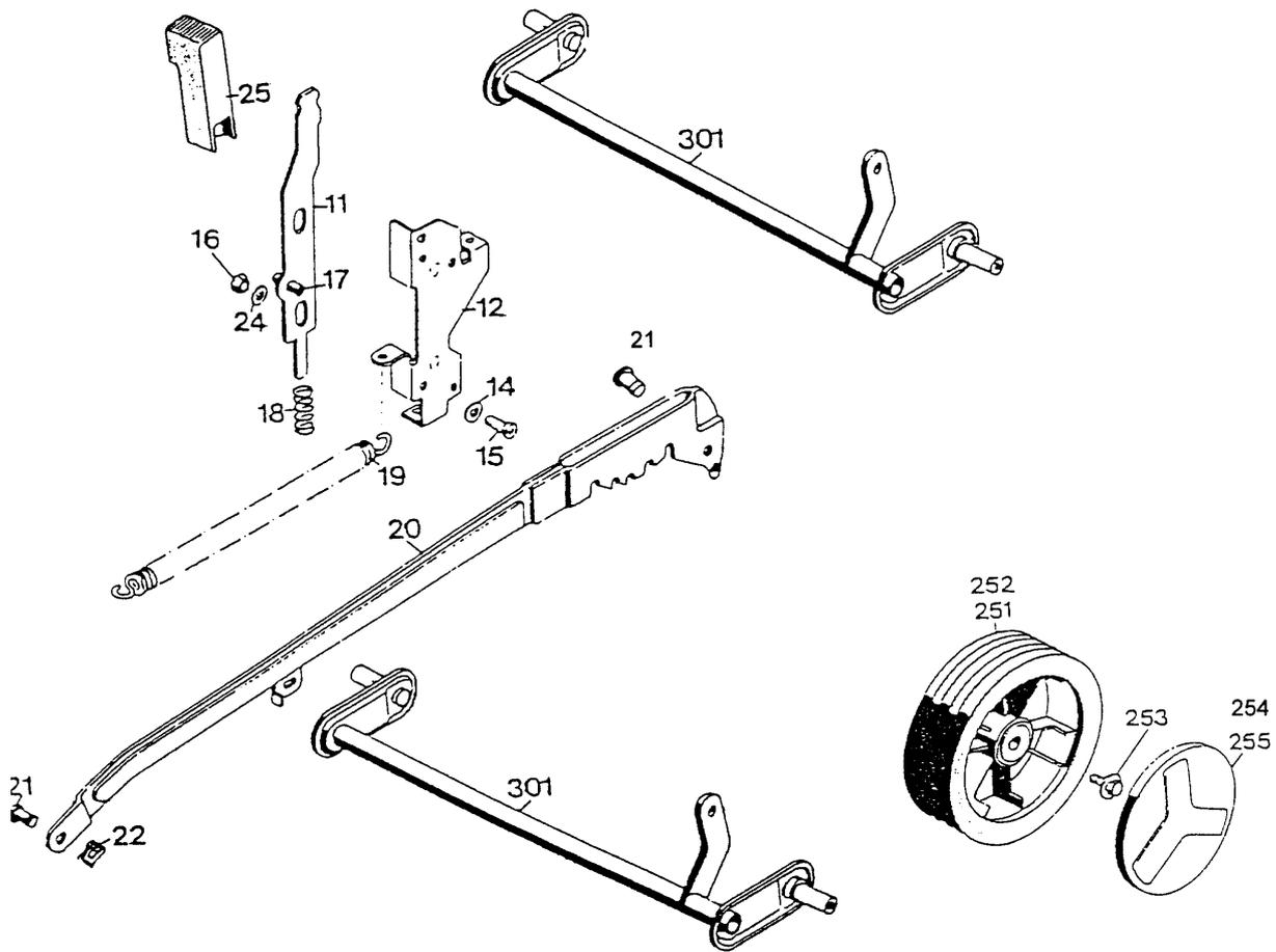
**Gerät: 2.42 TL (Achse, Höhenverstellung, Räder)**
